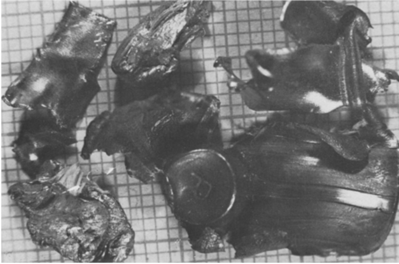
Abb. 3. Splitter eines TM-Geschosses, das bei 500 m/s unter 30° auf Beton aufprallte
